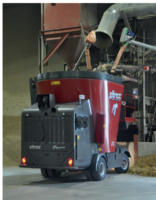
Les mélanges sont réalisés par des mélangeuses peseuses verticales. La pesée à une précision de 2 kg et la réalisation du mélange est suivi par caméra.
